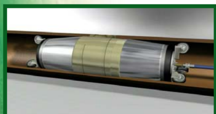
Se infla el packer manteniéndolo a presión durante el tiempo de ...
